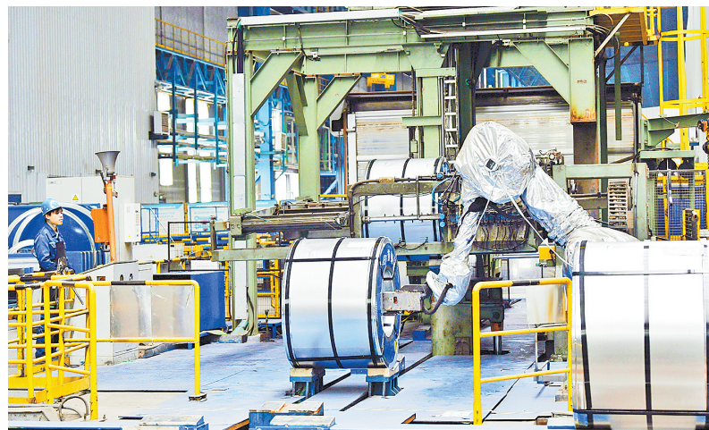
首钢迁钢公司热轧作业部酸洗板材作业区,机器人在给钢卷贴标。
